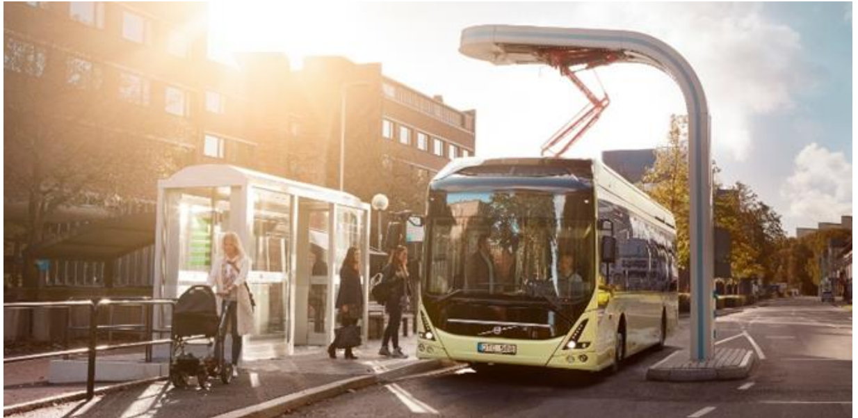
Bild: pantograf ner koncept med en Volvo elbuss i Göteborg
