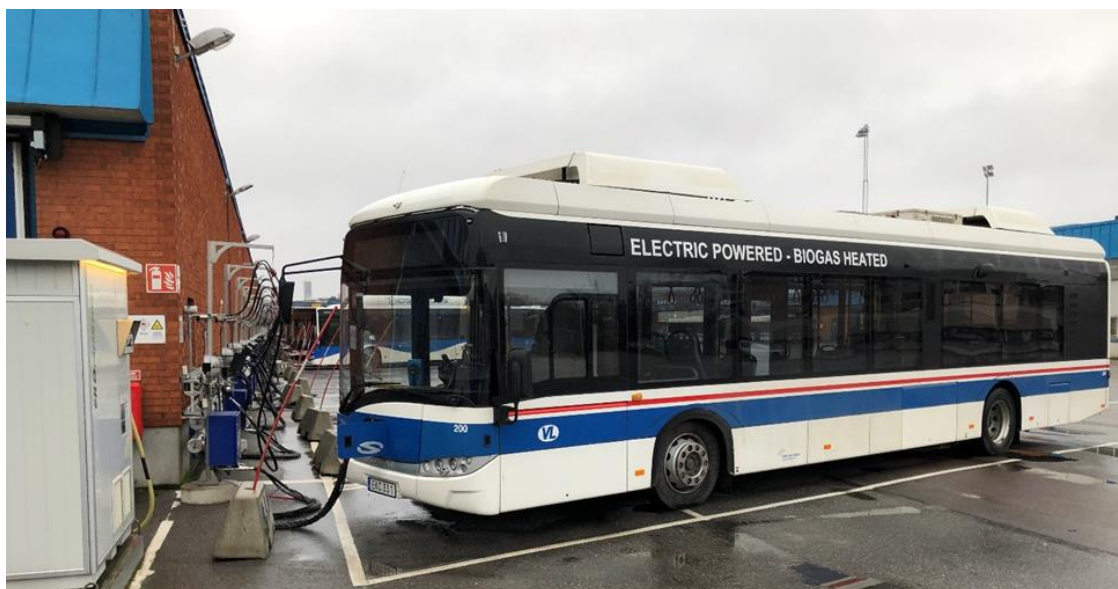
Bild: vår befintliga Solaris elbuss vid sin EkoEnergetica laddare på depå Retortgatan
