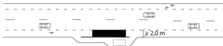
Figur 7: Utformning av vägrenshållplats. (Källa: TRV 2015:086)
